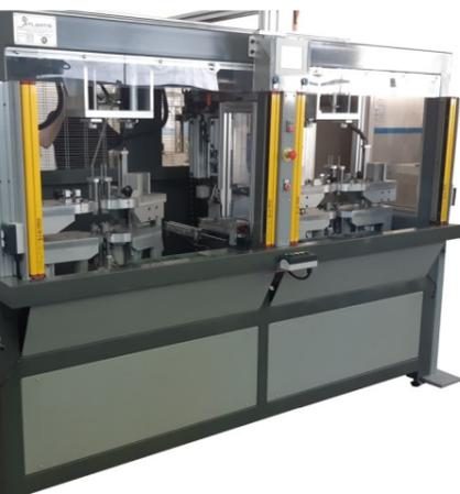
La macchina esegue in automatico le operazioni di cavatura ed introduzione molla, piastrina e spine.
