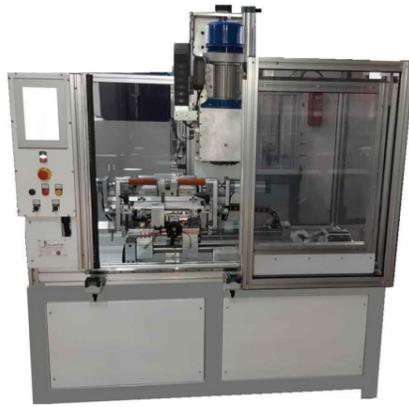
La macchina esegue in automatico le operazioni di fresatura creste delle forme in plastica.
