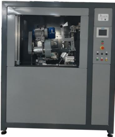
La macchina esegue in automatico l'operazione di fresatura e foratura dei due fori delle forme snodate a "V"
