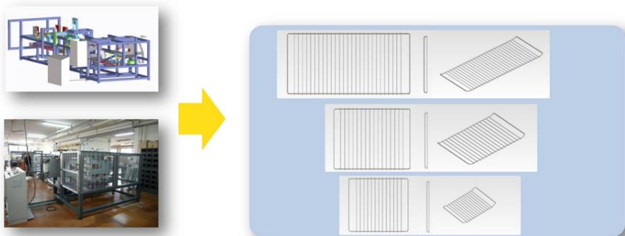
**SALDATRICE AUTOMATICA CON TELAI MOTORIZZATI**
